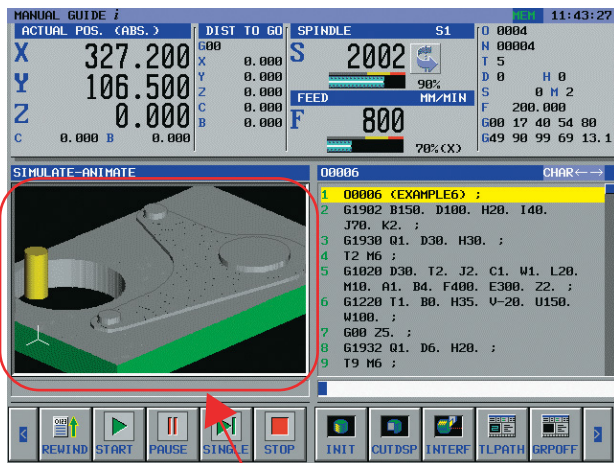
ミリング加工アニメーション例 Example of animated drawing of milling
